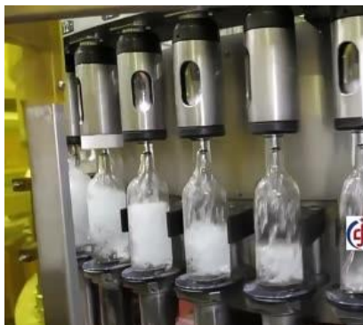
灌装产线高透明瓶的通过检测
