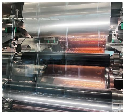
薄膜卷绕装置的有无检测
